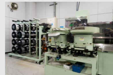
全自動圧接ハーネス製造機
